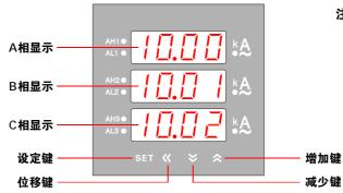
注: k指示灯被点亮时,表示仪表单位已切换 到kA; AH1、AH2、AH3指示灯被点亮时, 分别表示仪表A、B、C相电量示值已超过 上限报警设定值; AL1、AL2、AL3指示灯被 点亮时,分别表示仪表A、B、C相电量示值 已低于下限报警设定值;
